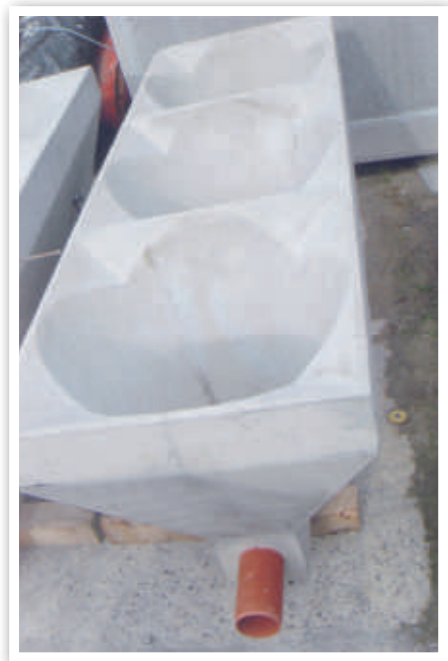
Verdens første dambrugskegler i beton – her på plads i Løvlund Dambrug
