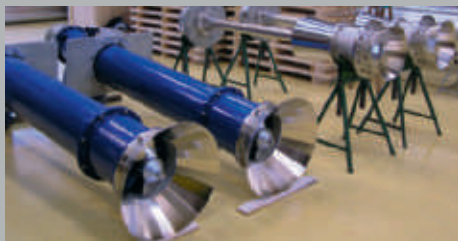
Pumper til renseanlæg, 2 til 5 % faststof
