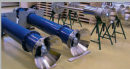
Pumper til renselanlæg, 2 til 5 % faststof
